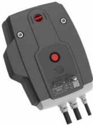
Le ONE-X est un composant unique du système ZENiX : un servomoteur à ressort de rappel avec une module de communication ZENiX intégré. Il est préassemblé sur le clapet coupe-feu, ne nécessite aucun adressage ou configuration et est immédiatement prêt à être connecté. Le ONE-X permet de gagner du temps lors de l'installation, de réduire les erreurs de câblage et d'économiser de l'espace.
