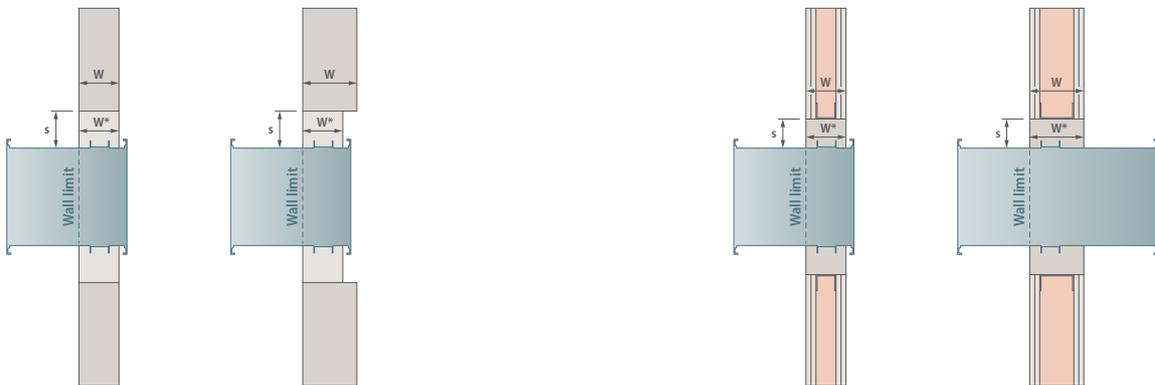
Si l'ouverture autour du clapet coupe-feu est plus grande que ce qui est indiqué dans la fiche technique, les options suivantes sont possibles : réduire l'ouverture dans la paroi en utilisant le même matériau que la paroi ; appliquer un autre système d'étanchéité ; demander un autre avis auprès d'une autorité locale compétente (éventuellement en concertation avec Rf-t). Il faut toujours tenir compte de la stabilité de la paroi et du bon fonctionnement du clapet coupe-feu.
